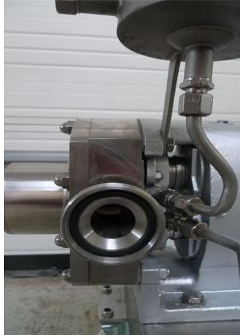
Betriebsdrucktest bei 2 bar
